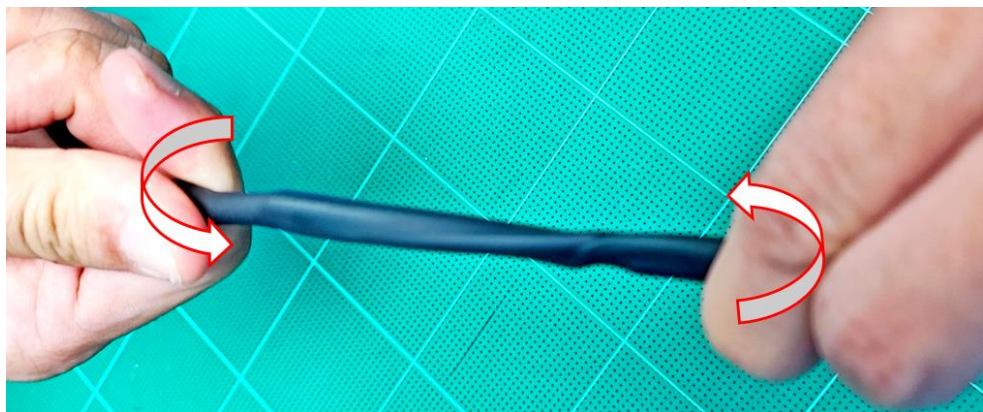
ภาพประกอบที่ 35. ทดสอบบิดจุดเชื่อมต่อสาย N-MA for FTTx แบบเปิดระยะสายสั้น
