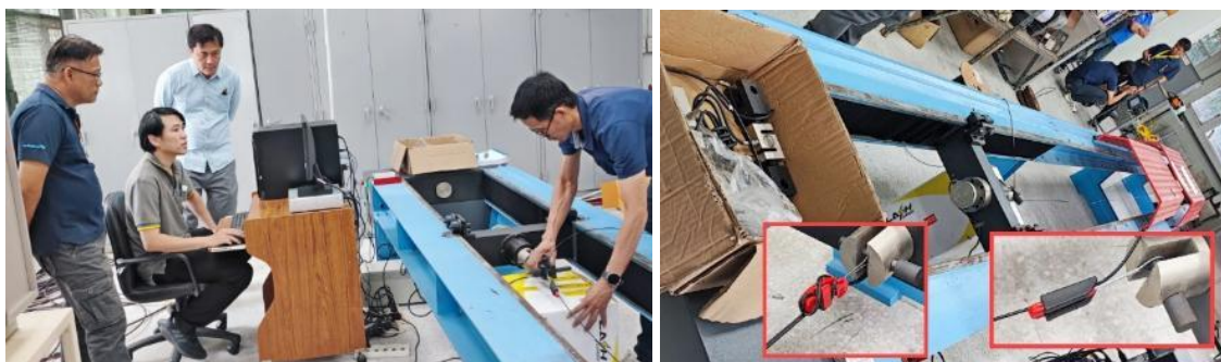
ภาพประกอบที่ 18. ทดสอบแรงดึงระหว่างอุปกรณ์จับยึดกับสาย Fiber Drop Cable
