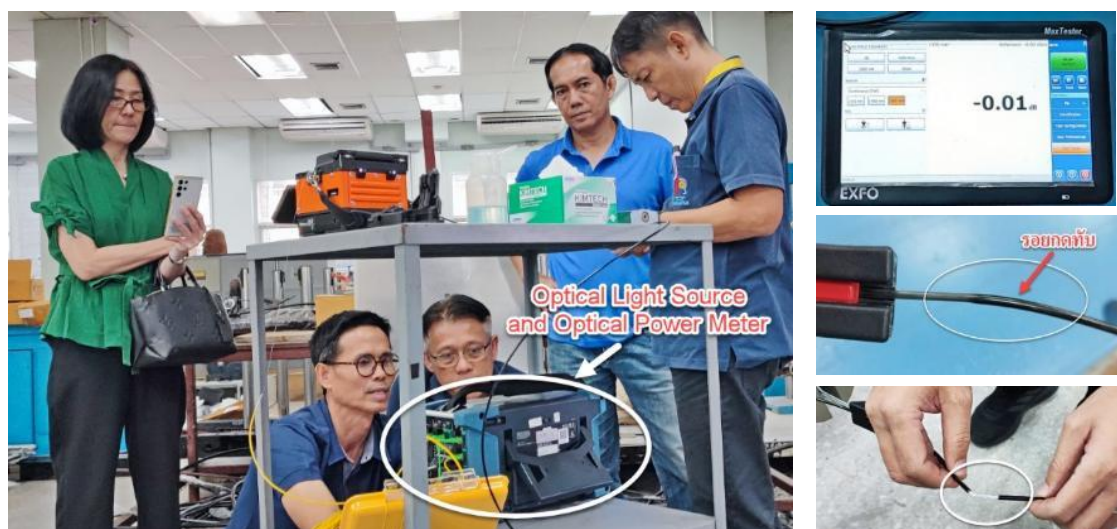
ภาพประกอบที่ 19. ป้อนสัญญาณแสงตลอดการทดสอบและแสดงตัวอย่างที่เสียหายจากการทดสอบ
