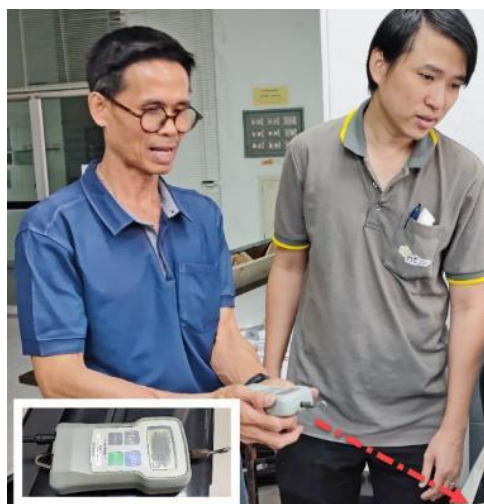
ภาพประกอบที่ 17. ทดสอบแรงเสียดทานระหว่าง Tight Buffer กับวัสดุห่อหุ้ม
