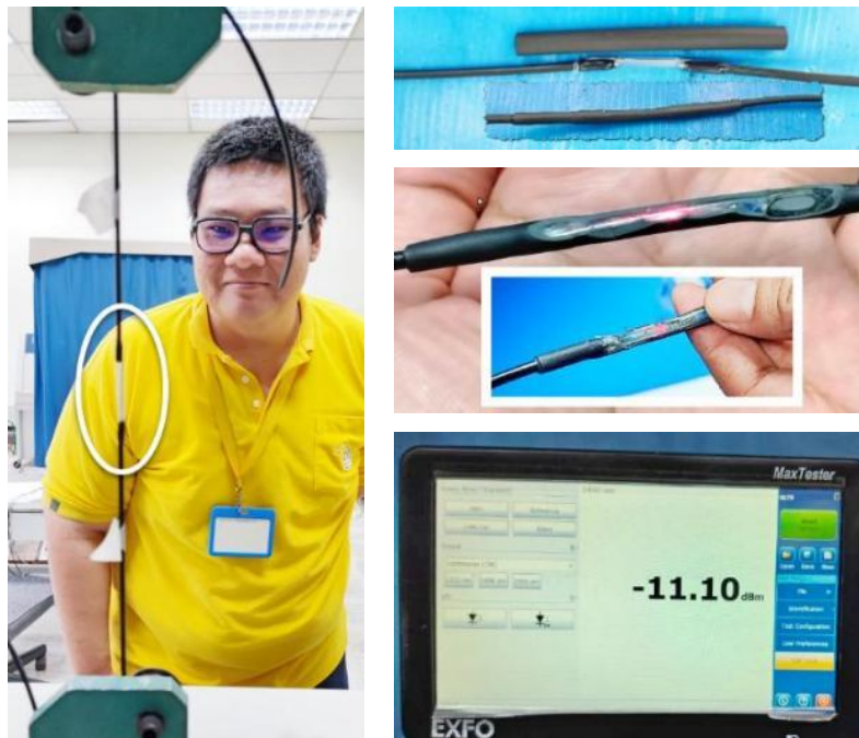
ภาพประกอบที่ 21. ทดสอบ “แรงดึง” จุดเชื่อมต่อเส้นใยแก้วนำแสง
