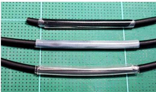
ภาพประกอบที่ 27. คุณภาพ Protection Sleeve และการตั้งค่าอบความร้อนมีผลกับจุดเชื่อมต่อฯ
