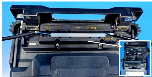
ภาพประกอบที่ 27. คุณภาพ Protection Sleeve และการตั้งค่าอบความร้อนมีผลกับจุดเชื่อมต่อฯ
